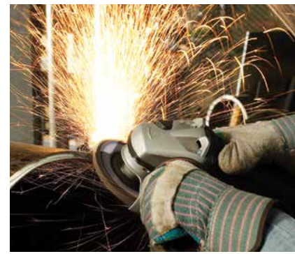
Biselado de tubería en borde con un disco laminado Tiger Paw.
