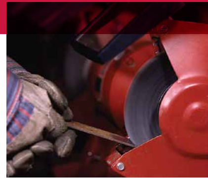
Limpieza de óxido de una pieza de acero al carbón con un cepillo circular de alambre ondulado.
