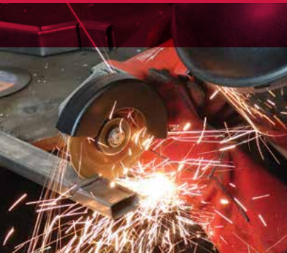
Disco UltraCut realizando cortes de precisión en un tubo de acero.
