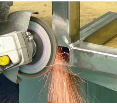
Desbaste de soldaduras en una pieza de acero fabricada.
