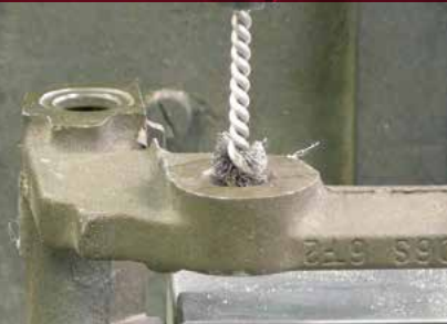
Eliminación de recubrimiento de zinc en barrenos en un soporte de freno.
